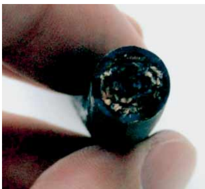
Zeit zum Wechsel: Viele Autofahrer wissen nicht, dass ein Gummi-Bremsschlauch ein ganz gewöhnliches Verschleißteil ist. Ein alter, zugequollener Gummischlauch lässt Bremsmanöver lebensgefährlich werden. Bild: Dickhaut-Specials
